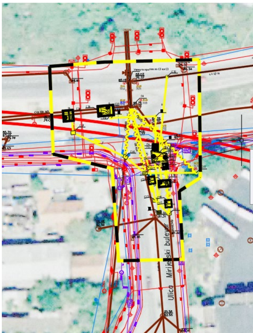
Слика 2: Локација прикључка канализационог колектора \varnothing FAC 600 mm на Деоницу 8 Интерцептора
